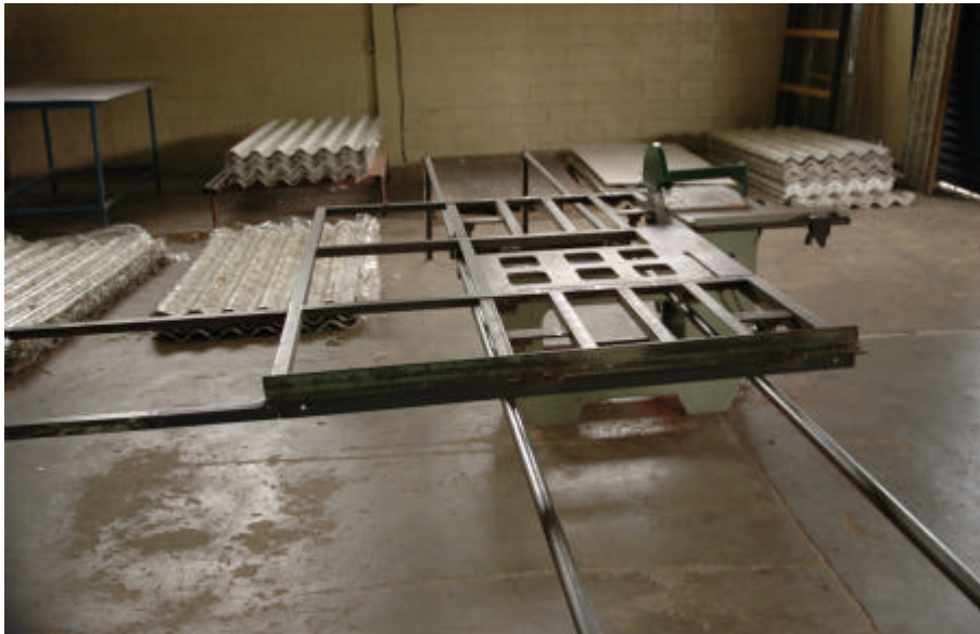
Figura 15 – Esquadrejadeira e Cortadeira para Placas e Telhas
