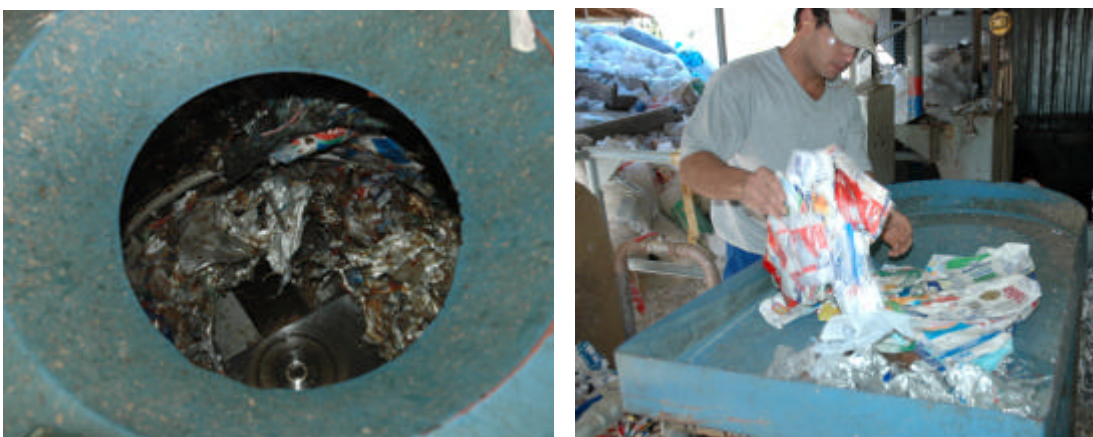
Figura 3 – Desagregador operando com embalagens longa vida pós-consumo
