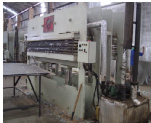
Figura 14 – Prensa Aquecida a fluido térmico
