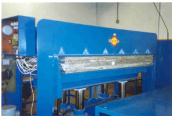
Figura 13 – Prensa Aquecida elétrica
