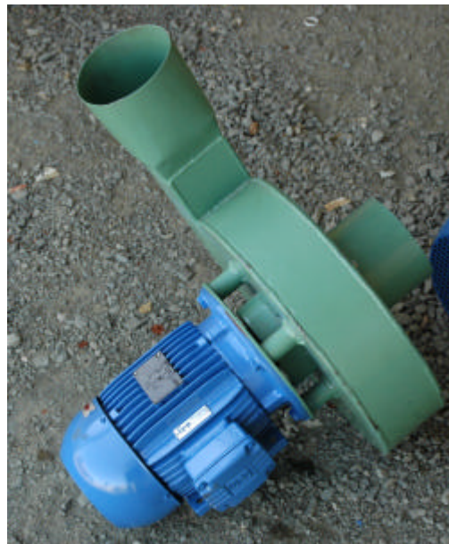
Figura 11- Ventoinha para transporte pneumático
