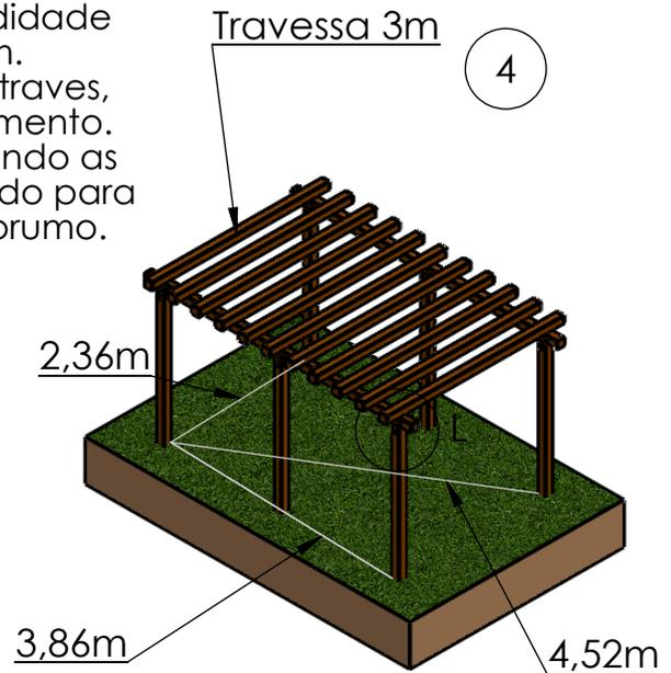
**3º)** Monte as longarinas na parte superior seguindo a furação existente nas travessas. Fixe os parafusos com uma chave Phillips no local indicado na figura 5.
