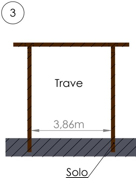
**2º)** Cave os buracos obedecendo as medidas da figura 4, com profundidade mínima de 60cm. Introduza os pés das travessas, respeitando o alinhamento. Compacte o solo fixando as travessas, tomando cuidado para ficar nivelado e em prumo.
