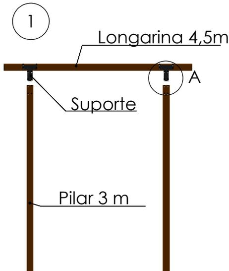
**1º)** Para montar as travessas, deite a travessa no chão com os suportes na horizontal. Insira os dois pilares nos suportes e fixe as peças como mostra a figura 2, utilizando a chave phillips.
